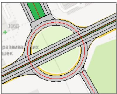
5. Чтобы убрать элементы основной дороги внутри кольца, воспользуйтесь инструментом **Разрезание полос** и удалите ненужные участки.
