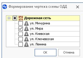
При нажатии кнопки **ОК** открывается окно предварительного просмотра чертежа. В нижней части окна расположены закладки листов чертежа. В списке в левой части окна отображаются слои итогового чертежа. Обратите внимание, что на чертёж передаются только те слои, видимость которых включена на момент формирования чертежа. Чтобы отобразить в списке все слои, в разделе **Общие настройки** нужно снять флаг **Удалять пустые слои**.
