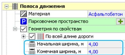
Добавьте краевые полосы и обочины по всей дороге в прямом и обратном направлении. Чтобы добавить новый элемент дороги, перейдите на вкладку **Главная** и выберите необходимый элемент в выпадающем меню кнопки **Элементы дороги**. При создании некоторых элементов дороги есть возможность их добавления сразу по всей длине дороги. Такие элементы имеют дополнительные подпункты режима создания: **По всей дороге в прямом направлении** и **По всей дороге в обратном направлении**.
