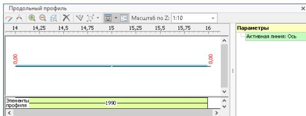
По умолчанию продольный профиль имеет две точки в начале и конце оси с высотными отметками равными 0,00, соединёнными прямой линией. На его основе система автоматически создаёт один элемент продольного профиля — прямая без уклонов.
