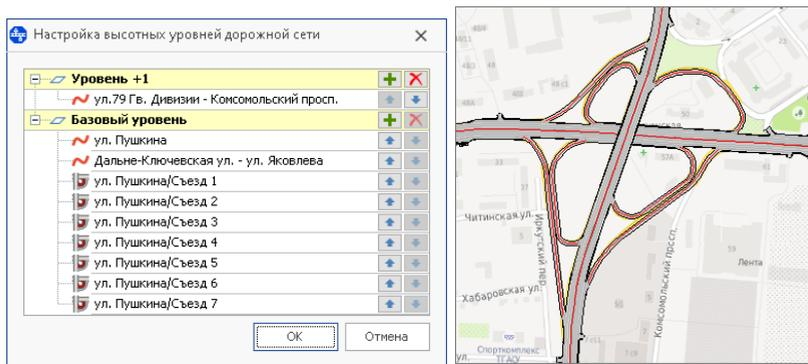
Элементы развязки не отображаются на спрямлённом плане, поэтому работа с ними (например, добавление и удаление элементов дороги, объектов ситуации и обустройства) происходит только на карте. Информация об объектах, входящих в состав элементов развязки, попадает в ведомости по дороге, в составе которой создана эта развязка.
