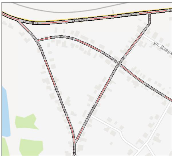
Ещё раз отметим, что работать сразу со всей сетью дорог можно только в режиме **Карта**. Спрямлённый план каждой дороги в проекте по-прежнему доступен в режиме **Схема дороги**. На спрямлённом плане дороги, входящей в улично-дорожную сеть, оси примыкающих к ней дорог отображаются как примыкания и автоматически подписываются.
