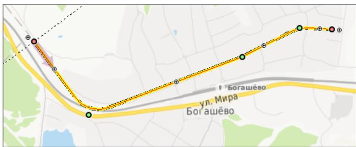
Геометрию оси можно редактировать, перемещая вершины непосредственно на карте или изменяя их параметры в инспекторе объектов. В свойствах вершины можно задать её координаты на карте, а для кривой, вписанной в эту вершину, указать радиус дуги и длины входящей и исходящей клотоид.
