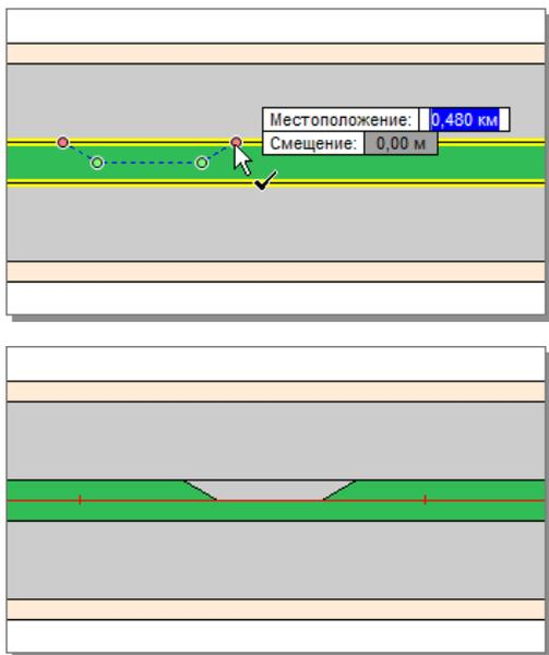
Данная возможность упрощает формирование элементов дороги при обустройстве уширения дороги за счёт разделительной полосы.
