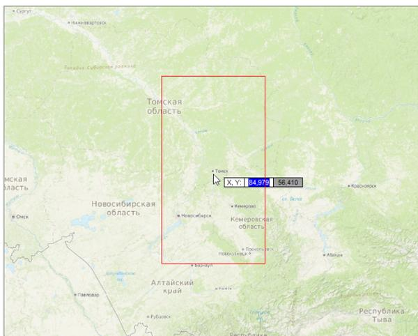
Для задания рабочей области расположите красный прямоугольник таким образом, чтобы в него попадала зона, где располагается дорога, а затем щелчком мыши зафиксируйте рабочую область. Когда задаётся рабочая область, к карте применяется проекция Гаусса-Крюгера, а в качестве осевого меридиана используется значение долготы, которое отображается в поле X. Таким образом программа подбирает проекцию, дающую наименьшее искажение на участке проектирования.
