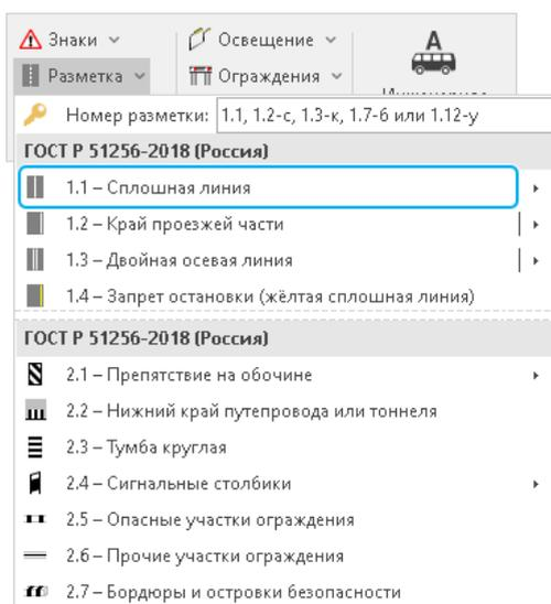
Для создания линейно-протяжённой разметки щёлкните мышью в первой точке на линии привязки, а затем в конечной точке на линии привязки. Или задайте положение начальной и конечной точки в полях динамического ввода. В нашем случае разметку следует создать вдоль всей дороги.
