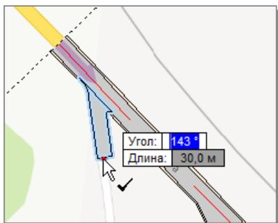
После создания примыкания его свойства отображаются в инспекторе объектов. Здесь можно указать название примыкания, изменить его расположение, длину и ширину, выбрать материал дорожного покрытия у примыкания.
