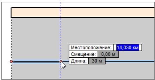
В некоторых местах на дороге разметка 1.1 прерывается. Заменяем разметку 1.1 на разметку 1.7 «Полоса движения на перекрёстке» на примыкании. Разрежьте разметку 1.1 в начале и в конце примыкания, выбрав пункт
