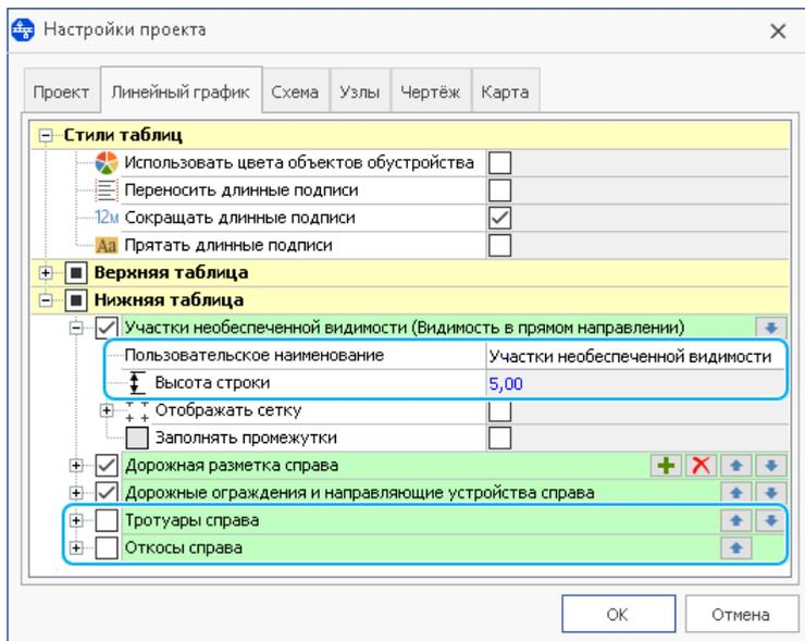
3. На дороге «ул. Мира» отсутствуют откосы и тротуары. Чтобы информация о них не отображалась в линейном графике, в разделах **Верхняя таблица** и **Нижняя таблица** снимите соответствующие флаги.
