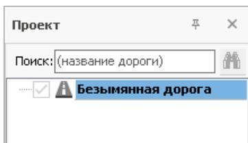
Главный элемент автомобильной дороги — это проектная ось. Она имеется в составе любой дороги. По оси вычисляется километраж автомобильной дороги, к ней привязываются дорожные объекты. В простом случае (например, дорога третьей категории) существует проектная ось, которая проходит по середине проезжей части.
