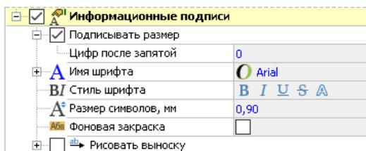
Отображение подписей пикетажного положения дорожной разметки настраивается в свойствах слоя **Горизонтальная разметка** в разделе **Метки местоположения**.
