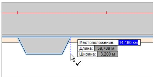
Параметры кармана остановки можно отредактировать на схеме с помощью управляющих точек или в инспекторе объектов, уточнив положение элемента, ширину и отгоны.
