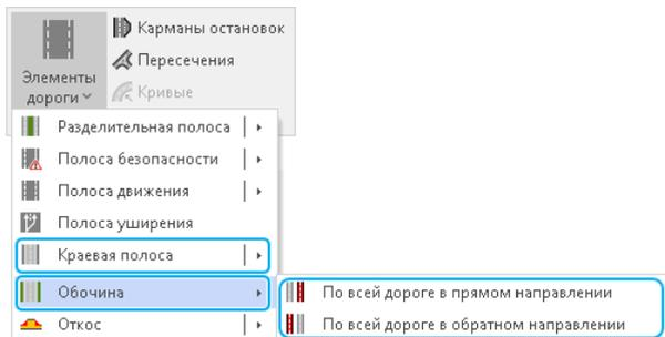
Добавим на схему карман остановки. Для этого выберите элемент **Главная > Дорога > Карманы остановок** и щелчками мыши на схеме укажите начало и конец элемента. С помощью полей динамического ввода можно задать точное положение, длину и ширину элемента дороги в процессе его создания.
