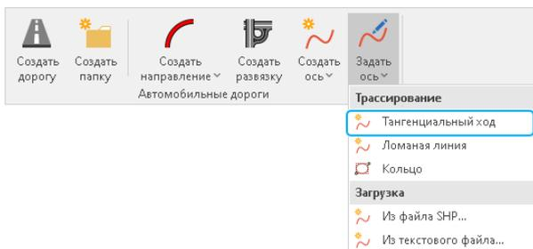
Последовательными щелчками мыши укажите на карте опорные вершины, по которым будет построена ось. Для завершения построения дважды щёлкните мышью в последней точке.
