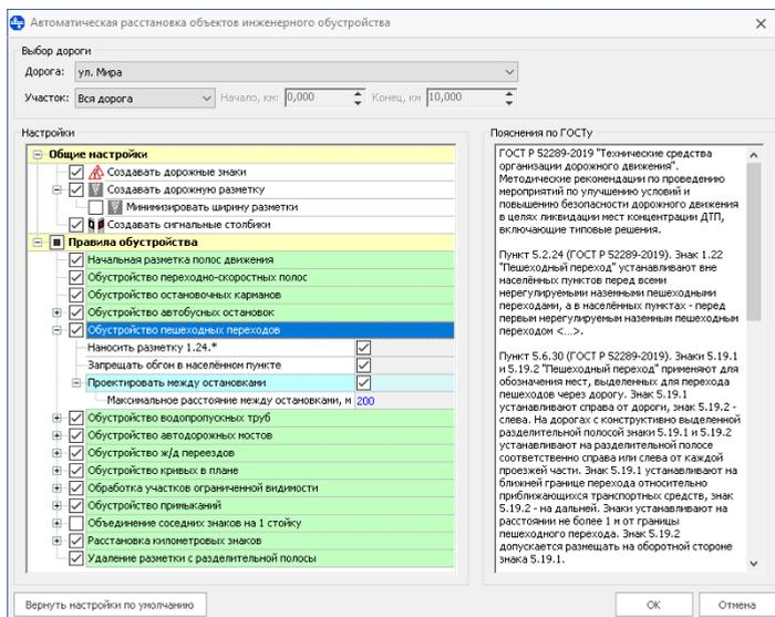
**СОВЕТ.** Создайте объекты **Пешеходный переход** с типом конструкции **Наземный** в местах на дороге, где предполагается нанесение соответствующей разметки и знаков, чтобы система автоматически расставила необходимые средства ОДД. После автоматической расстановки объектов инженерного обустройства удалите созданные вручную объекты **Пешеходный переход**, чтобы избежать дублирования информации в ведомости пешеходных переходов.
