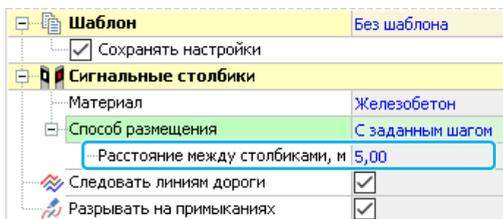
Чтобы создать столбики, щёлкните мышью в первой точке привязки, а затем в конечной точке. Столбики так же, как и другие объекты обустройства, имеют линии привязки и могут переходить с одной линии на другую.
