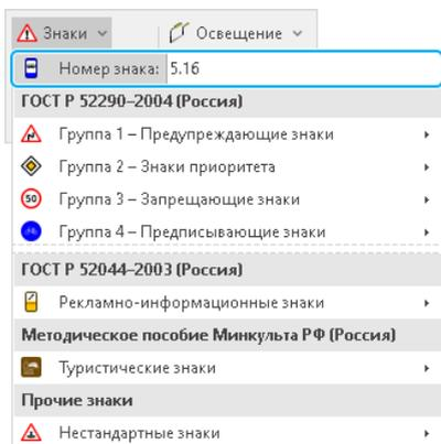
Щелчком мыши установите знак на схеме, затем сдвиньте указатель в сторону, подобрав длину выноски дорожного знака, и вторым щелчком мыши укажите положение изображения знака на схеме дороги.
