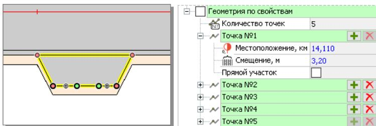
Перейдём в режим карты. На карте видно, где к дороге «ул. Мира» примыкают другие дороги. Чтобы создать их, включите режим построения примыканий, нажав кнопку **Главная > Дорога > Пересечения**. Щелчком мыши укажите положение примыкания на дороге, затем сдвиньте указатель мыши в сторону, подобрав угол и длину примыкания, и вторым щелчком мыши завершите построение. Точное местоположение примыкания, его угол и длину можно задавать в полях динамического ввода.
