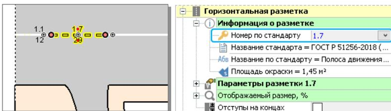
Добавим разметку 1.2 «Край проезжей части» по краю проезжей части дороги. По умолчанию разметка повторяет изгибы дороги. Если линейно-протяжённая разметка частично переходит с одной линии привязки на другую линию (например, обозначается край проезжей части при наличии автобусного кармана или полосы уширения), то в процессе создания нужно указать дополнительные точки, фиксирующие переход разметки с одной линии привязки на другую.
