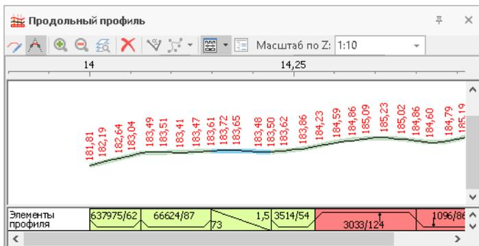
На графике элементов продольного профиля можно контролировать, соответствуют ли элементы профиля ограничениям автомобильной дороги:
