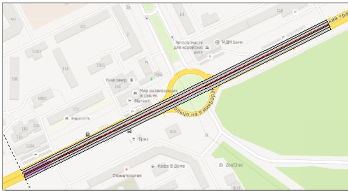
2. В составе основной дороги создайте развязку и добавьте новый элемент развязки. Для этого элемента выберите способ задания оси **Кольцо** и нанесите его на карту. В режиме создания кольцевой оси в инспекторе объектов можно выбрать способ построения окружности.
