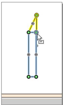
В инспекторе объектов в поле **Описание** можно указать, чем является выбранный элемент застройки. Эта информация отображается на плане. Внешний вид застройки (контур, заливка, подпись) настраивается в свойствах слоя **Застройка**.
