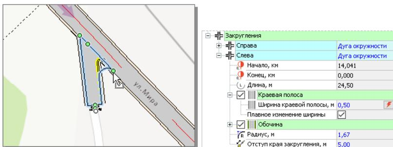
Для подписи примыкания отображаются управляющие точки, с помощью которых можно перемещать и поворачивать подпись. При этом она выравнивается по горизонтальным, вертикальным линиям и линии оси примыкания. Также при редактировании местоположения подписи можно воспользоваться полями динамического ввода. В свойствах слоя примыкания можно указать, какие параметры примыкания нужно отображать в подписи.
