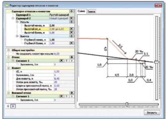
В редакторе шаблонов верха проектной поверхности можно определить количество полос движения и их параметры (ширины и уклоны), параметры обочин, наличие разделительной полосы и бордюров. В редакторе уширений можно создать заготовки для переходно-скоростных полос, автобусных карманов, бордюров и других элементов дороги, а затем применять эти шаблоны при проектировании.
