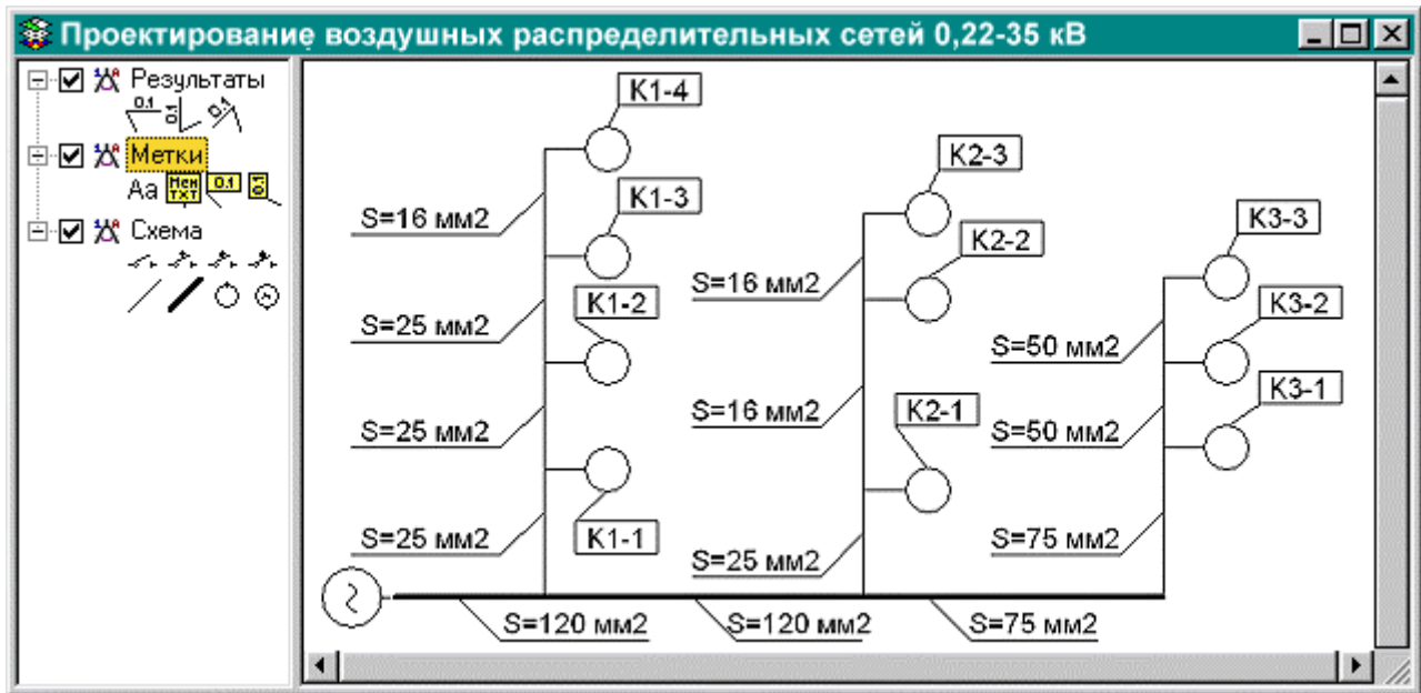
Рис. 6. Выбор сечений проводов воздушных распределительных сетей.
