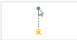
Привязка к вертикальным, горизонтальным и диагональным прямым, проведённым через зафиксированную точку привязки
