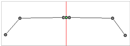
Пикет с поперечным профилем, полученным путём интерполяции значений
