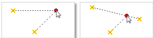
Привязка к точкам пересечений дополнительных прямых: точка пересечения горизонтальной и диагональной прямой; точка пересечения прямой, проведённой через две точки, и диагональной прямой
