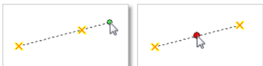
Привязка к прямым, проведённым через любые две точки привязки, и серединам отрезков, соединяющих эти точки
