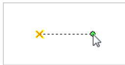
Привязка к вертикальным, горизонтальным и диагональным прямым, проведённым через зафиксированную точку привязки
