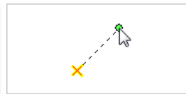
Привязка к вертикальным, горизонтальным и диагональным прямым, проведённым через зафиксированную точку привязки
