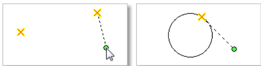
Привязка к перпендикуляру и к касательной
