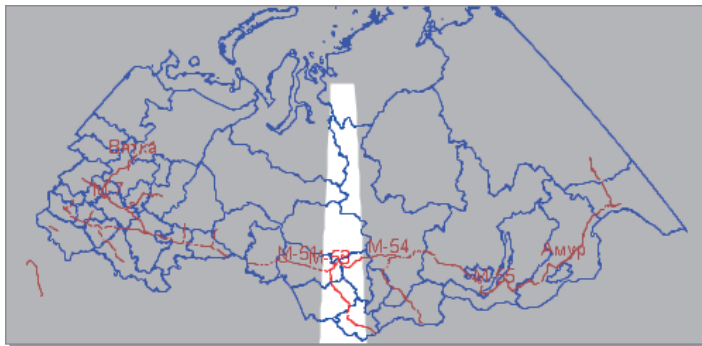
Расположение осевого меридиана проекции Гаусса-Крюгера
