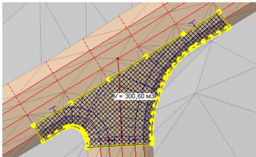
Создание контура для вычисления объёма насыпи
