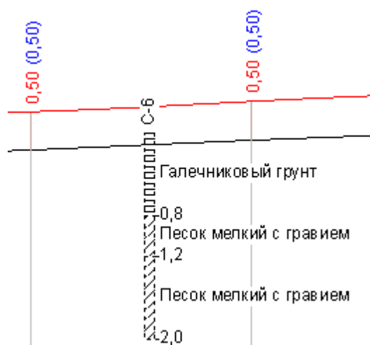
Отображение скважины в продольном профиле трассы
