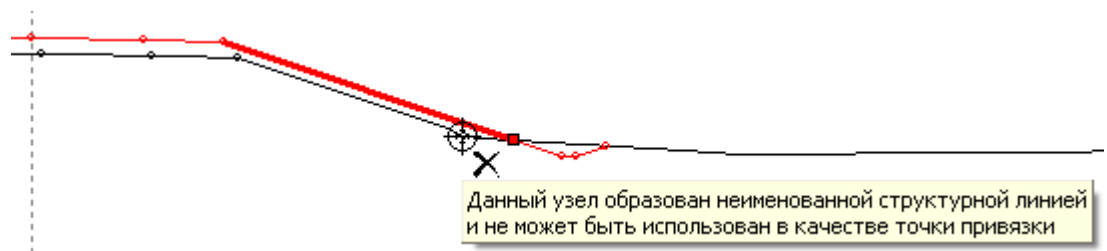
Попытка выбора в качестве точки привязки неименованного узла существующей поверхности
