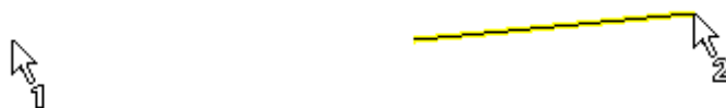
Построение отрезка: при выборе начальной и конечной точек отрезка рядом с указателем появляются цифры 1 и 2
