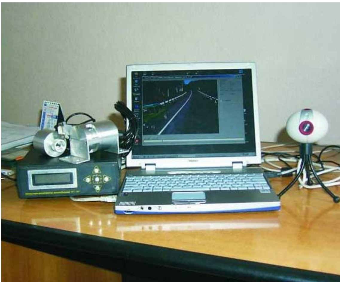
Рис. 4.11. Программно-аппаратный комплекс для создания видеорядов ИРА-3М (производитель ООО ИДЦ «Индор», г. Томск)
