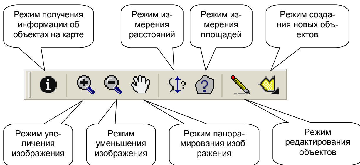
Рис. 1.3. Панель инструментов для выбора режима работы карты типичной ГИС на примере IndorGIS 5.0
