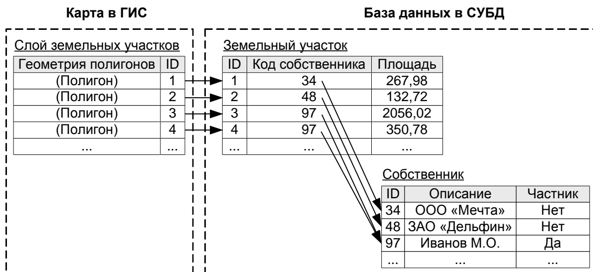
Рис. 2.14. Геореляционная база данных (слева - упорядоченный список пространственных объектов в слое карты, а справа - связанные с ними записи в базе данных)
